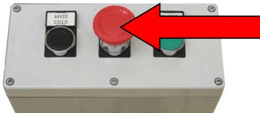
**Se si verifica la necessità di arrestare la macchina in qualsiasi momento del ciclo premere il pulsante di emergenza.**
