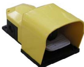
Per far compiere alla macchina un ciclo passo-passo , selezionare il senso di rotazione desiderato tramite il selettore (vedi pag. 17 "selettore")premere con un piede sul comando a pedale. Verificare che lo scorrimento dell'attrezzo sia libero in tutta la corsa. Questa operazione deve essere compiuta a stampo libero senza parti in lavorazione.
