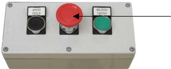
Controllare che il pulsante di emergenza non sia inserito e, se necessario, azzerare il contapezzi.
