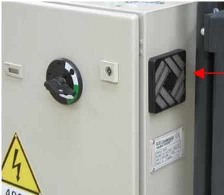
Pulire periodicamente con aria compressa, la griglia di ventilazione del quadro elettrico. Nel caso in cui sia deteriorata provvedere alla sostituzione. Verificare sempre l'efficienza dell'elettroventola
